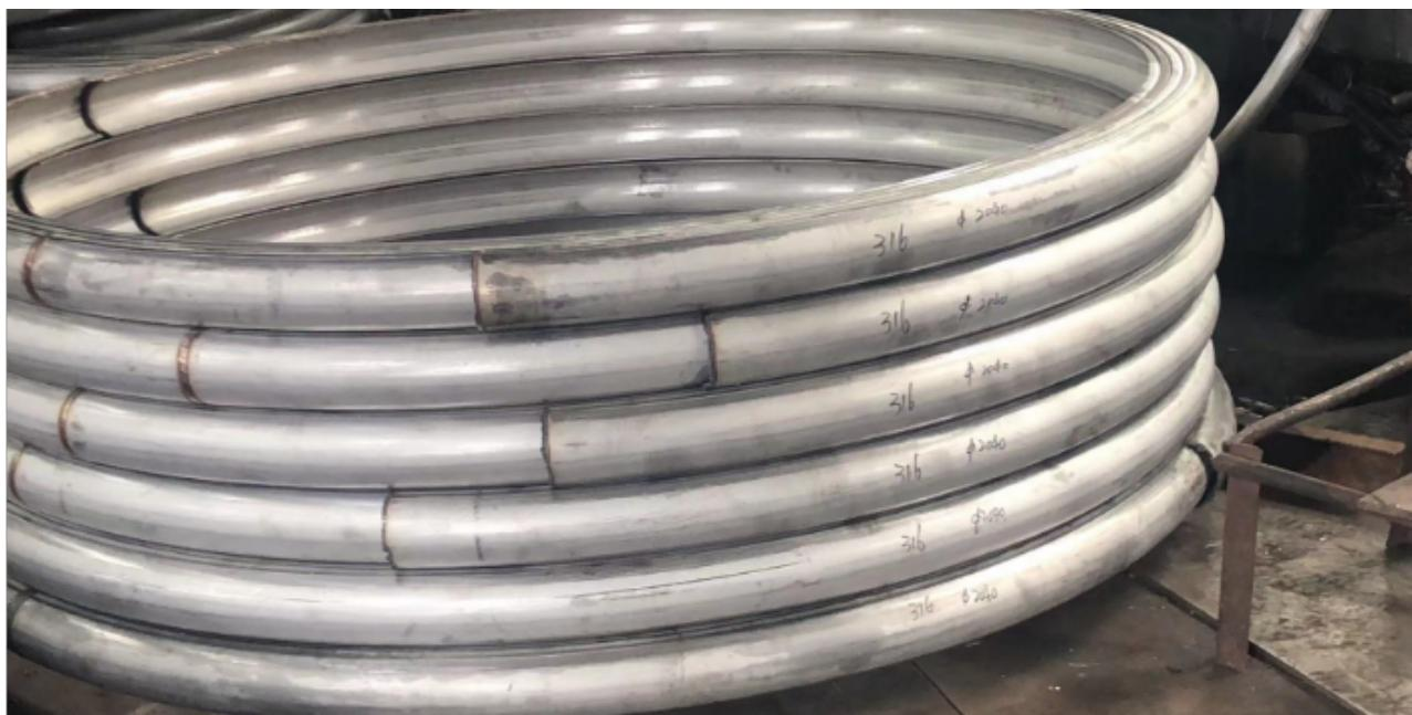
半圆管要是处于其长期进行存放，这样产品需要进行定期的检查，在使用时需要常常对外露的加工表面要进行保持清洁，及时的清理污垢，整洁的存放在室内透风干燥的地方，严禁堆置或露天存放。这需要常常保持其弯头的干燥和透风，在使用时需要保持器的清洁以及整洁，按照其准确的存放方法进行存放，在进行安装时，可以将其按照其连接方式直接装置在管路上。如果我们想要半圆管能够获得好的使用效果，并且具有更长的使用寿命的话，那么对于半圆管的保养工作就不能松懈了，我们要做到这几点：1. 每隔半个月就对半圆管进行除尘工作，一般来说使用抹布擦掉灰尘就可以了。2. 一般来说如果半圆管的内外表有麻点、黑点的话，我们可以用水进行清洗。3. 如果要对半圆管进行检测以及整形的话一定要进行离线处理，还有一点要记住，那就是一定不要使用酒精擦洗！4. 还有一点就是注意不要让半圆管接触到酸性介质，否则的话它就会被腐蚀掉。苏州换热盘管无锡日之尧科技的弯管物美价优，有想法不要错过！
