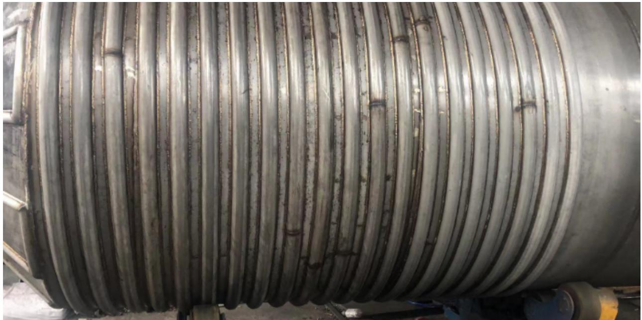
在制作半圆管的过程中，防生锈是一个非常重要的环境。如果防生锈的工作没有做到位的话，那么后期往往会影响半圆管的使用情况。所以我们还是需要在制作半圆管的过程中，做好相对应的防锈工艺。首先我们一定要从原材料的质量抓起，也就是说，在进行制作半圆管之前，我们要保障所用原材料的质量是符合半圆管工艺加工要求。并且还要将其表面所存在的不同污物给清理干净。对于半圆管表面的处理，小编在此给各位提出三点比较好用的方法哦！1. 乳化处理：使用乳化和溶剂对半圆管表面清洗作为腐蚀制作的辅助方法，因为它不能除去管材表面的氧化皮，通量和生锈，但它可以清洗刚，表面去除油脂，一类有机化合物，润滑油和灰尘。2. 喷射除锈处理：喷射除锈不但能清理半圆管表面的氧化物，铁锈，和磨料和钢管的摩擦和撞击力也能达到所要求的表面粗糙度均匀的使用。3. 除锈处理：生锈钢铁表面倾斜，规模和焊渣，除渣方法可用于清洁的工具，即磨钢丝刷工具的表面。但如果钢表面的氧化皮，盖固定，除锈效果并不理想，因为动力工具清理可以达到3级手动工具除锈，因此选择除锈方法根据实际情况。半圆管哪家好？请认无锡日之尧科技。苏州换热盘管
